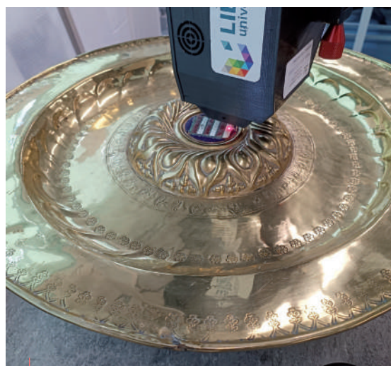
Analyse met een draagbare XRF van een bassin uit het Promatech-corpus. Foto Grégoire Chêne.
