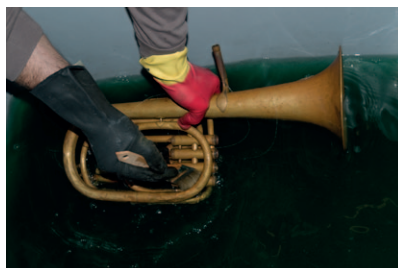
3 De saxhoorn wordt in een chemisch bad gelegd om oxidatie te verwijderen.
